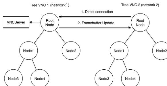
図 6 遠隔地 Node からの接続
