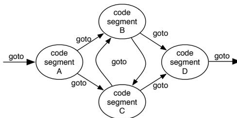
図 1: goto による code gear 間の継続
