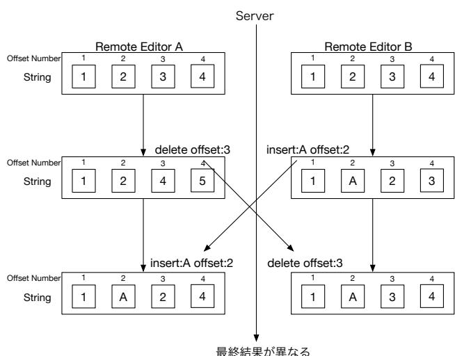
図 1: 通信によるオフセット位置のずれ
