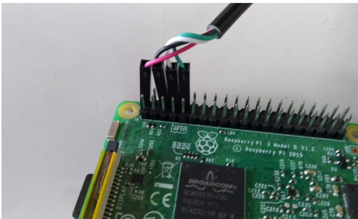
図 3.1: Raspberry Pi と シリアルコンソールの USB 変換ケーブルの接続
